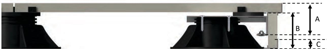
La chiusura verticale in lastre di gres è trattenuta da due profili perimetrali in alluminio (A - C) a cui si fissano delle piastre in acciaio avvitate ai piedistalli perimetrali.
