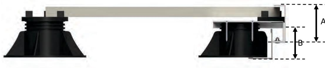
Il perimetro in acciaio oltre alla funzione di contenimento del pavimento si congiunge agli angoli con basamenti in acciaio su cui fissare le colonne di pergole e gazebo, senza dover eseguire fori sulla pavimentazione di sottofondo.
