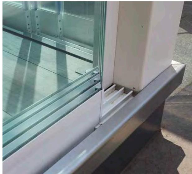
La trave perimetrale dispone di un alloggiamento regolabile atto ad incassare la guida delle vetrate (per guide larghe 5 cm fino a 12 cm (a richiesta anche 14 cm).
