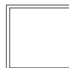
Sezione gamba 40x40 mm spessore 1,5 mm
